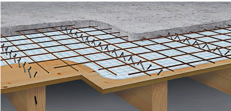
Schematischer Aufbau: Holzbalkendecke, Folie, Schubverbinder, Bewehrung, Betonschicht.
